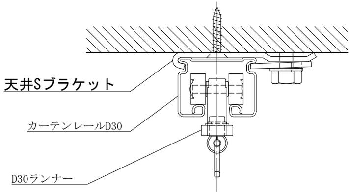
図1 レールの構造
